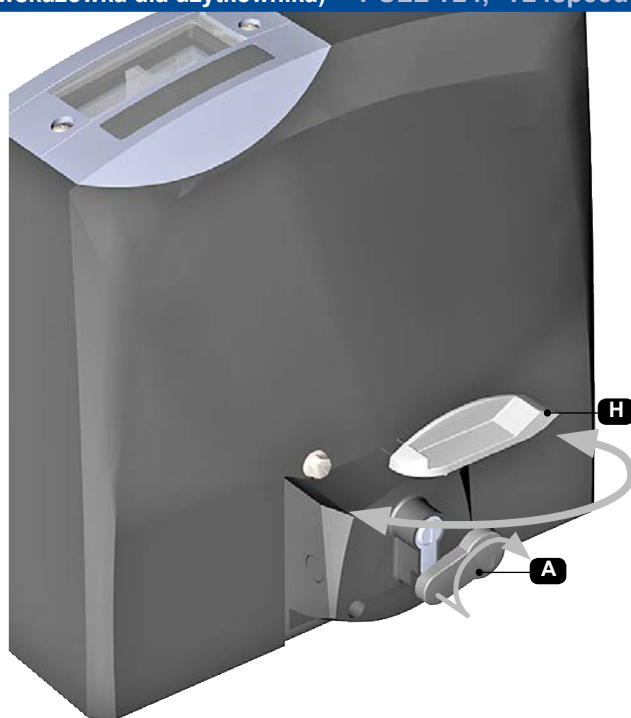
Ilustracja pokazuje dźwignię w pozycji odryglowanej
